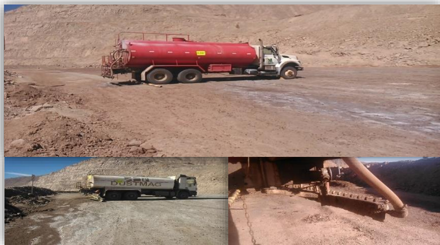
Figura 15: Modelo de Camiones Aljibe que se ocupan para aplicar producto.
